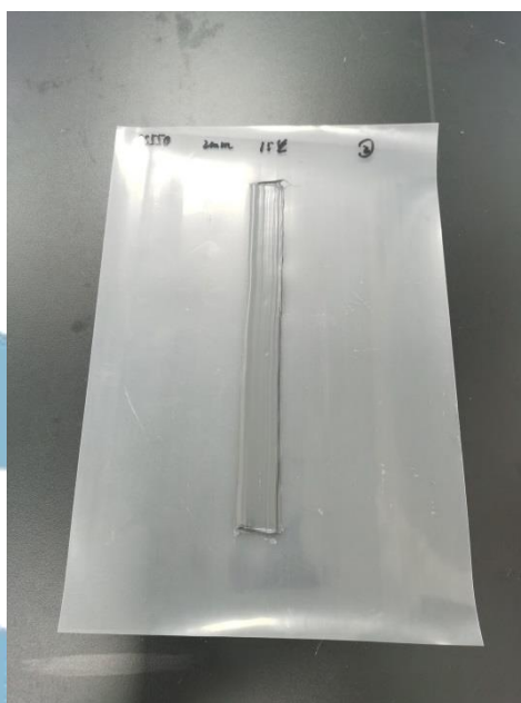
b) 无烷烃增塑剂的试样（正面）
